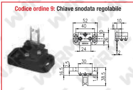
Per testine di comando modello K3000, K4000, K5000 (dimensioni in mm.)
